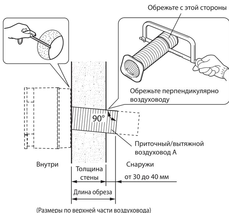
2) Обрежьте приточный/вытяжной воздуховоды А перпендикулярно оси трубы, длиной, указанной на рисунке выше.
