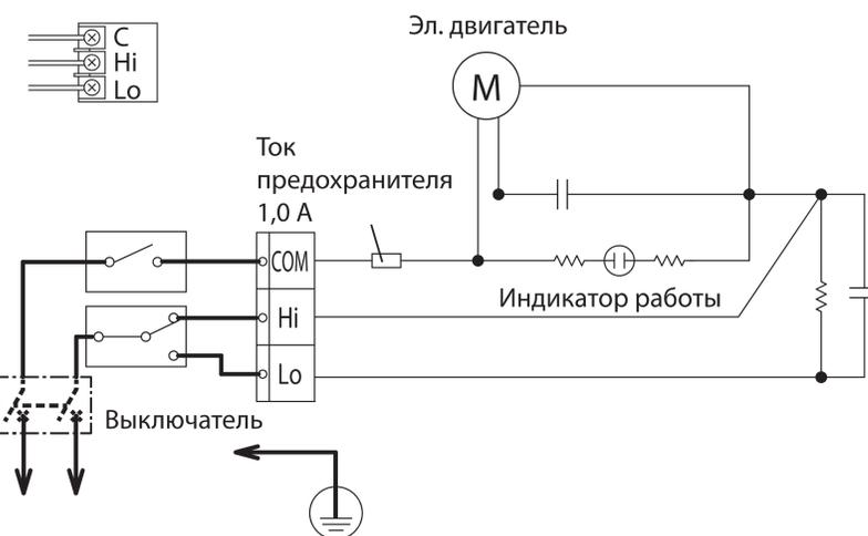
8) Прикрепите заземляющий кабель к клеммной колодке винтом заземления для обеспечения заземления.
